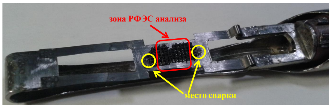
Рисунок 2.8 – Танталовая сборка с приваренным образцом структурированного катализатора.
