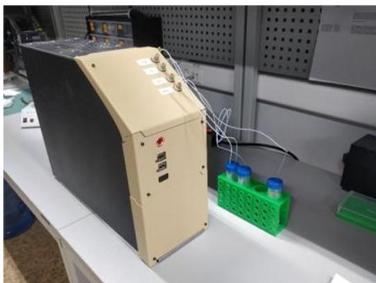
Рисунок И.2 Прибор для мультиплексного иммунологического анализа
