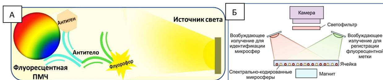
Рисунок 2 Схемы иммуноанализа: с использованием флуоресцентных частиц (А) и флуоресцентных магнитных частиц (Б) [8]
