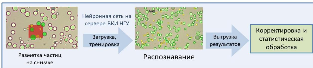
Рисунок 14 Схема обработки изображений полимерных частиц с использованием нейронной сети
