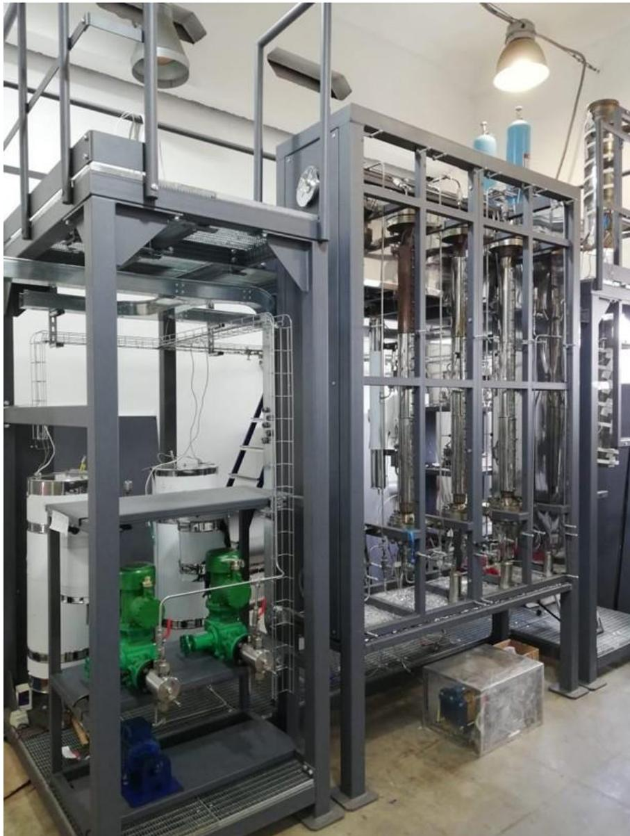
Рисунок 61 – Пилотная установка гидропереработки гудрона.
