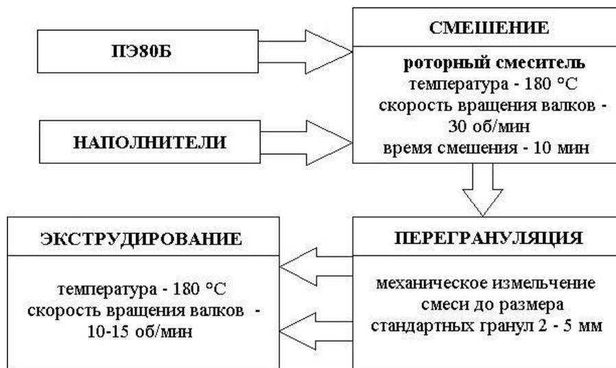
Рисунок 2.13 – Схема процесса изготовления ПКМ на основе полиэтилена
