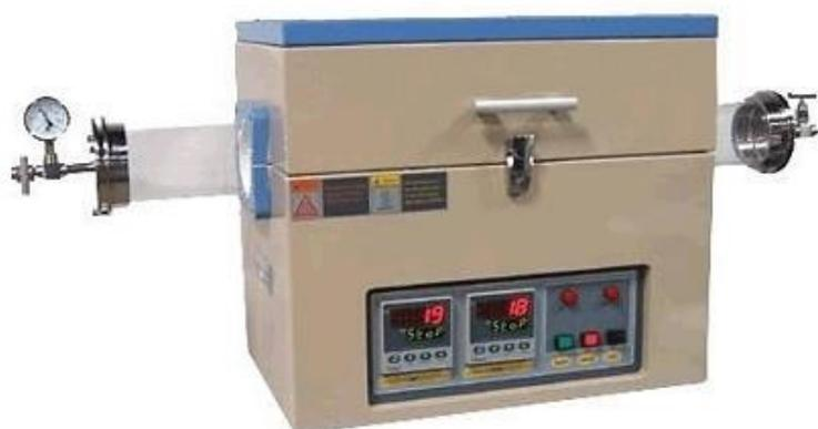
Рисунок 2.5 – Горизонтальная трубчатая печь XD-1200NT (Brother, Китай)
