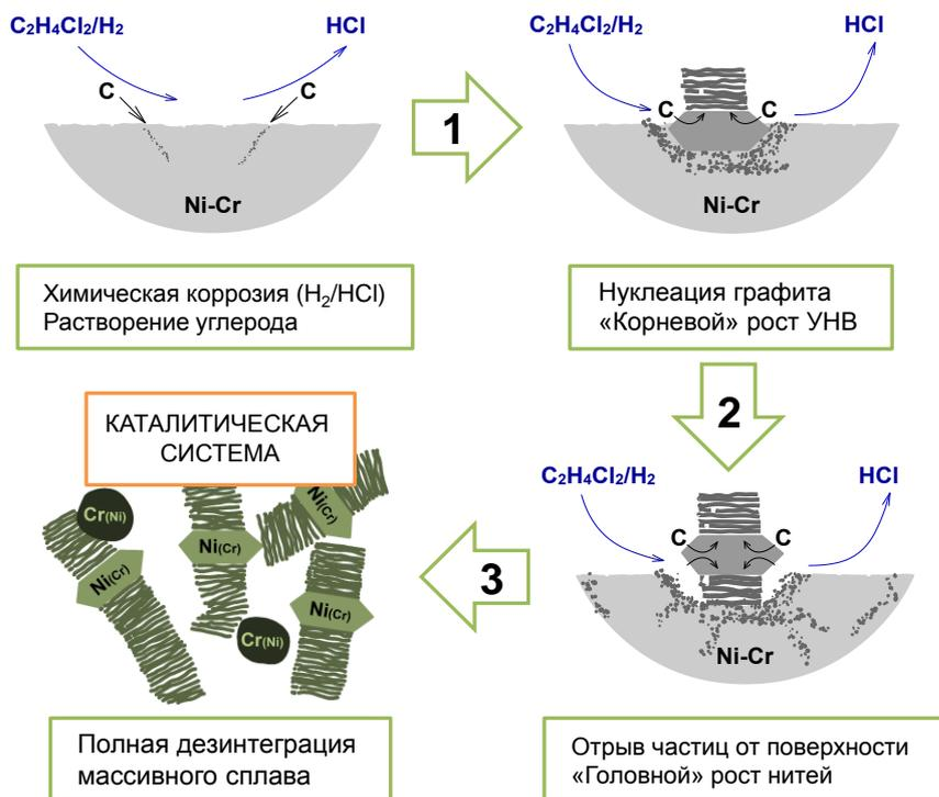
Рисунок 4.20 – Схема формирования самоорганизующегося катализатора в ходе углеродной эрозии массивного сплава Ni-Cr в реакционной смеси  $7\% C_2H_4Cl_2/38\% H_2/Ar$
