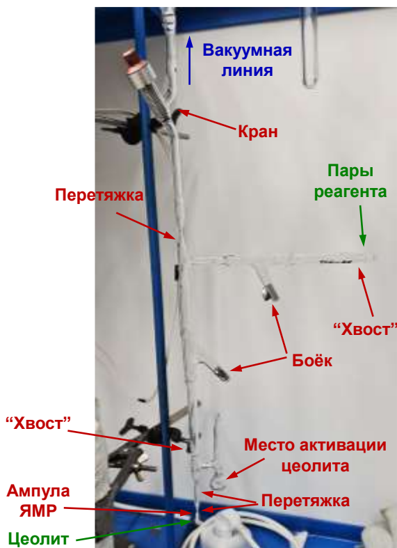
Рисунок 24 – Пример стеклянной цельнопаянной конструкции, которая используется для активации образца цеолита и последующей адсорбции на него малолетучего реагента; перетяжка – место перепайки, “хвост” – тонкое изогнутое стекло внутри цельнопая, которое отделяет одну часть конструкции от другой и которое можно разбить бойком; цеолит изначально активируется в специальном аппендиксе с большой площадью, на которой порошок распределён тонким слоем, за счёт чего вода удаляется более равномерно и быстрее по сравнению с относительно толстым слоем порошка в ампуле ЯМР
