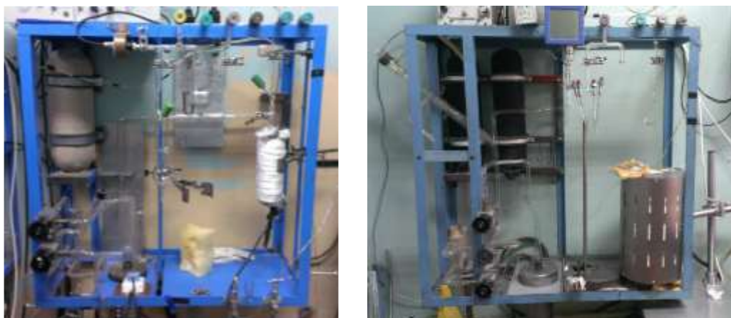
Рисунок 23 – Вакуумные установки, используемые для активации образцов цеолитов и адсорбции реагентов
